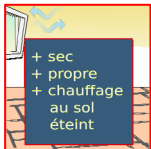
Condition préalable au traitement
